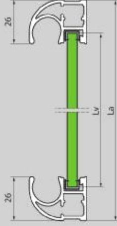
Расчет ширины заполнения толщиной 4 мм
